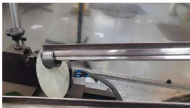
Figura 39 – Anéis de 50 milímetros acomodados no canal de desabastecimento
