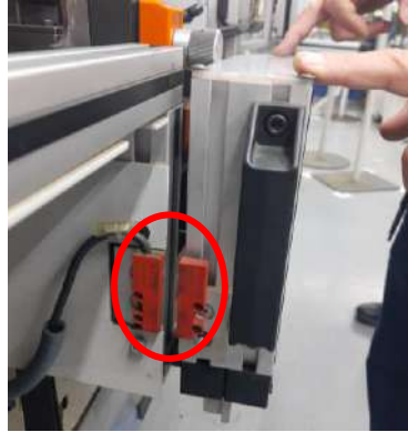
Figura 36 – Sensores impedidos de fechar contato
