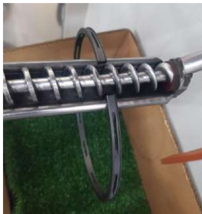
Figura 41 – Anel de 160 milímetros posicionado no fuso rotativo
