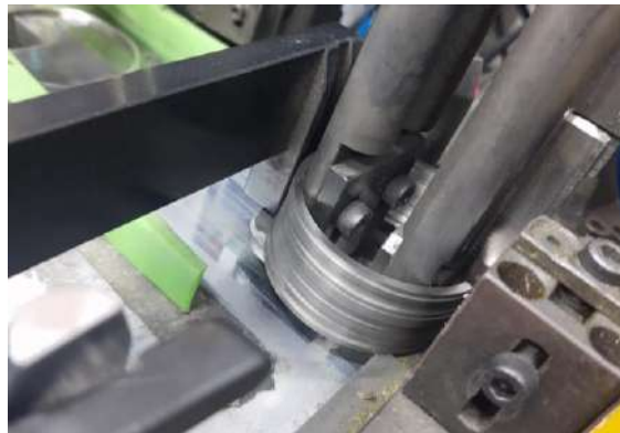
Figura 29 – Anel de 50 milímetros de diâmetro posicionado no sistema de abastecimento
