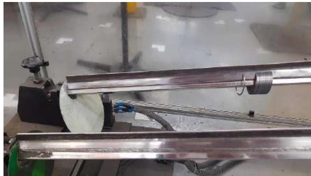
Figura 38 – Anéis de 50 milímetros se posicionando no canal de desabastecimento
