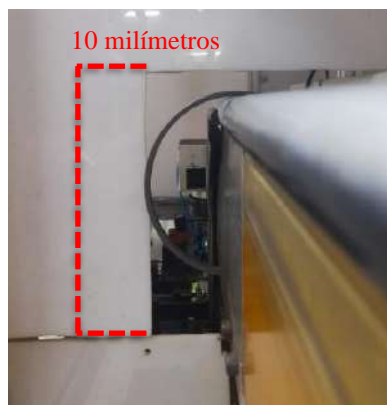
Figura 44 – Proposta para eliminação de restrição do magazine para anéis de 160 milímetros de diâmetro.
