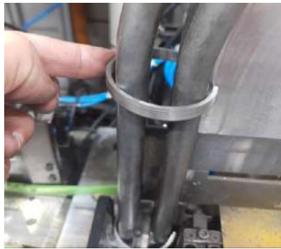
Figura 28 – Anel de 50 milímetros de diâmetro posicionado no sistema de abastecimento
