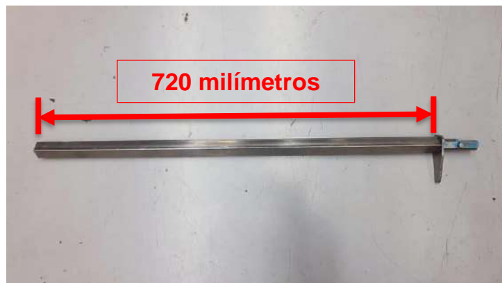
Figura 24 – Canal de 720 milímetros
