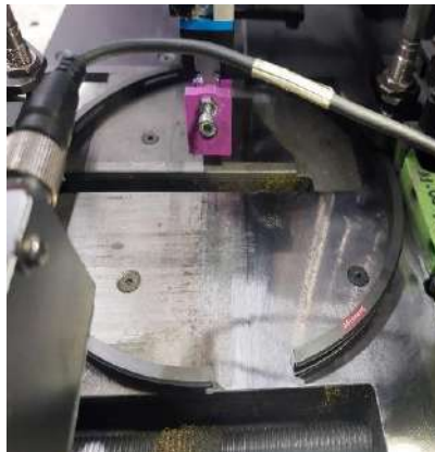
Figura 34 – Anel de 160 milímetros posicionado na pista
