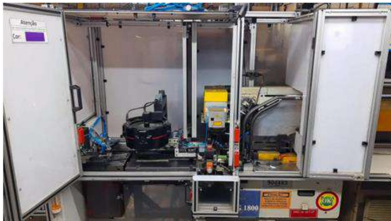
Figura 21 – Pista, sistema de inspeção e gravação dos anéis
