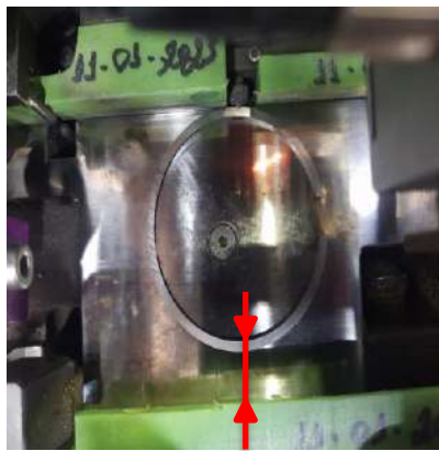
Figura 31 – Folga entre anel de 50 milímetros e as guias da pista
