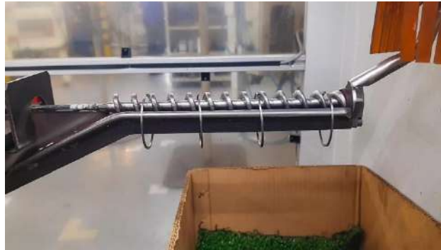
Figura 37 – Anéis de 50 milímetros sendo transportados pelo fuso
