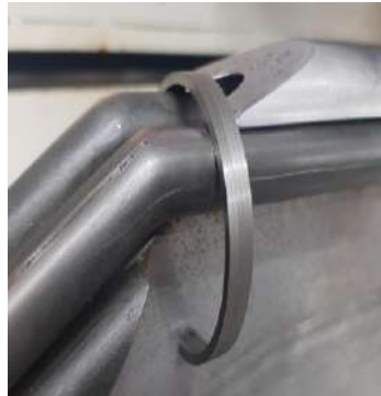
Figura 27 – Anel de 50 milímetros de diâmetro posicionado no sistema de abastecimento
