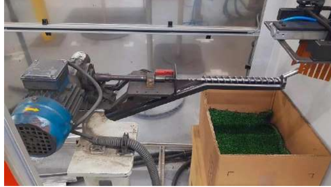
Figura 40 – Fuso rotativo para desabastecimento dos anéis
